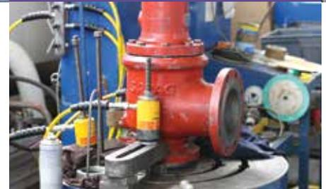
La maintenance comprend les contrôles après réparation et vérification d'étanchéité
